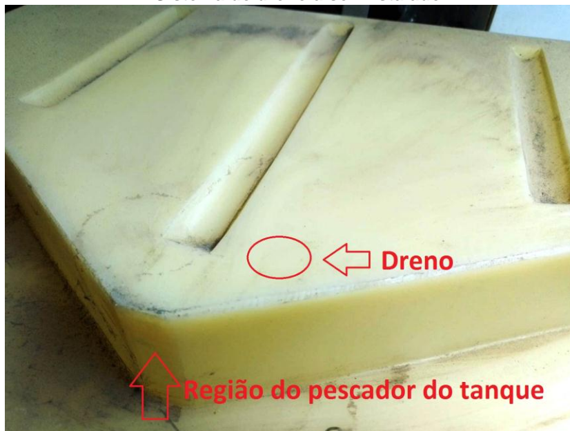
Figura 02 Localização do furo no tanque.
